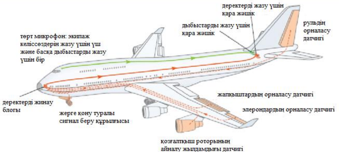
1.3 Сурет – ҰПАТЖ агрегаттарының Boeing 747 әуе лайнерінің бортында орналасуы
